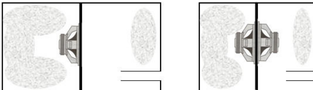
Til venstre: Båndpaskabinet med én driver - planche nr. 20. Til højre: Båndpaskabinet med to drivere i push-pull - planche nr. 21.
