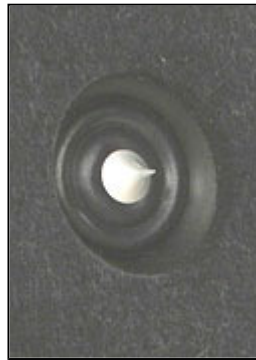
Scan Speak diskant omkranset med filt.
